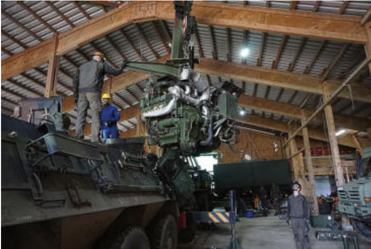
Das Triebwerk des Transportpanzers ist defekt. Mit einem Feldkran wird das beschädigte Triebwerk herausgehoben und das neue direkt eingebaut.
