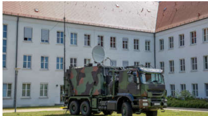
Das große DSÜ plus in der mobilen Version passt auf einem handelsüblichen Lkw.
