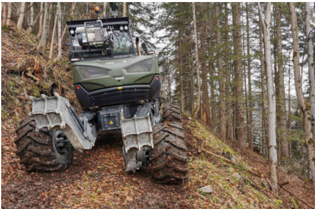
Der Schreitbagger im Einsatz auf dem Forstweg Richtung Pidinger Klettersteig.
